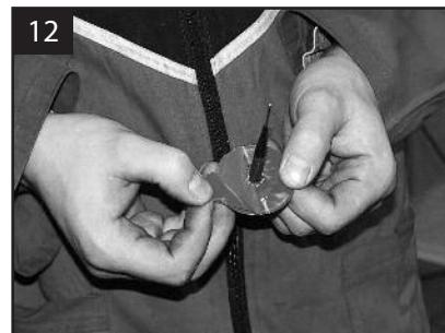
10. Промазываем отверстие под ножку грибка kleem A024 при помощи спирального напильника T109. Оставляем напильник в отверстии.
