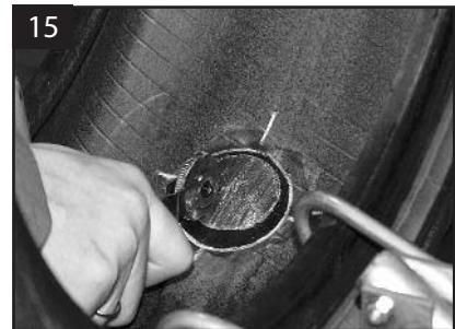
13. Вынимаем спиральный напильник из отверстия и вводим металлический кончик ножки грибка в отверстие с внутренней стороны шины.
