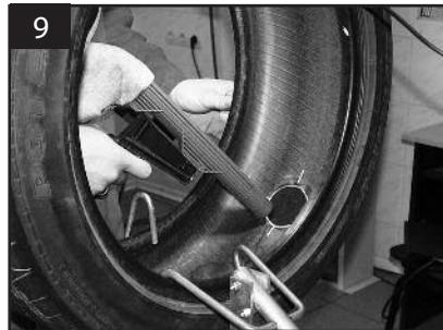
7. Еще раз обрабатываем место под шляпку грибка буферным очистителем А110, убирая грязь скребком Т103
