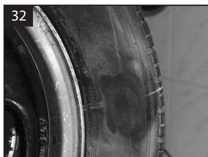
29. Обрабатываем края пластиря и защищенную изнутри поверхность шины герметиком внутреннего слоя A305, если шина бескамерная или тальком, если шина камерная.
