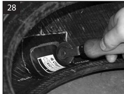
26. Совмещаем центр пластиря с центром повреждения и прижимаем его (центр пластиря) к подготовленной поверхности.
