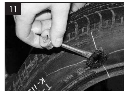
9. Определяем толщину резины шины в месте повреждения. Записываем мелом это значение на боковине шины для расчета времени вулканизации.
