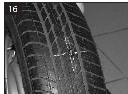
14. Накачиваем шину и проверяем место ремонта на герметичность. При утечке воздуха в месте ремонта вставляем еще один жгут, повторяя операции с 6 по 13.
