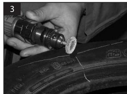
1. Определяем место расположения повреждения и отмечаем его мелом снаружи и изнутри шины.
