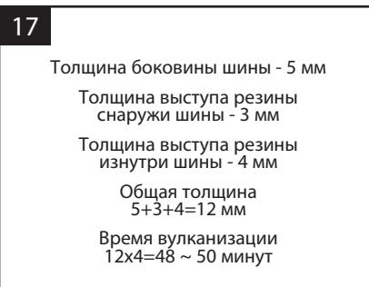
17. Рассчитываем время вулканизации из расчета 1 мм резины - 4 минуты вулканизации (при температуре вулканизации  $145^{\circ}\text{C}$ ). При использовании выравнивающей подушки время вулканизации увеличивается на 60 минут.
