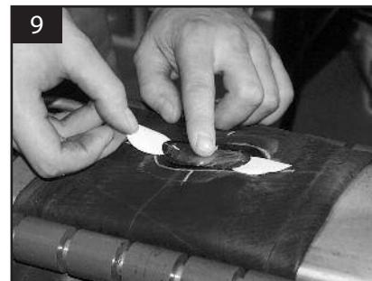
7. Наносим на подготовленную поверхность клей A024 от центра к краям равномерным слоем и даем ему высохнуть в течение 3-5 минут (до исчезновения блеска). Время сушки клея зависит от температуры и влажности окружающей среды и может быть увеличено.
