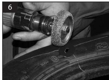
4. Удаляем стенки повреждения абразивным инструментом и низкооборотной дрелью (не более 2500 об/мин) или острым ножом.
