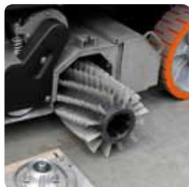
• Дека щеточного узла из нержавеющей стали
